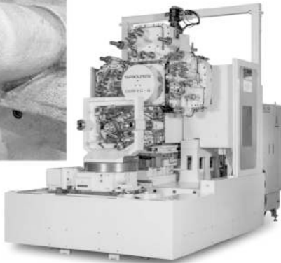
穴径補正装置を付けた軸（左上）とキュービック
